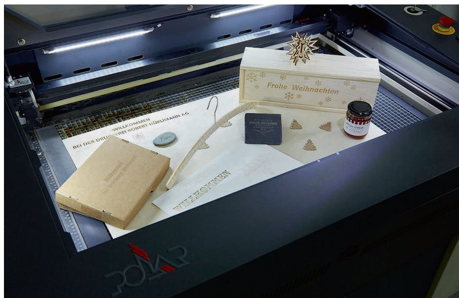
Auf dem Laserschneider Digicut schneidet, stanzt, graviert die Druckerei Robert Hürlimann AG dreidimensionale Körper aus unterschiedlichsten Materialien – Einzelstücke und kleinere Serien.
