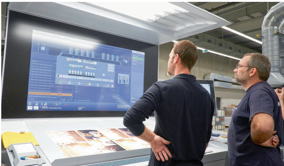
Auf Bogenoffsettechnik von Heidelberg weist die Bedienerführung Intellistart 2 dem Drucktechnologen den schnellstmöglichen Weg beim Wechsel von einem Druckauftrag zum nächsten.
